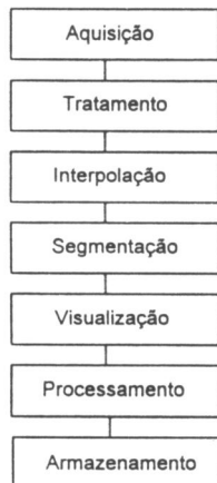
Figura 1 - Etapas de um sistema completo de Tomografia Computadorizada.
