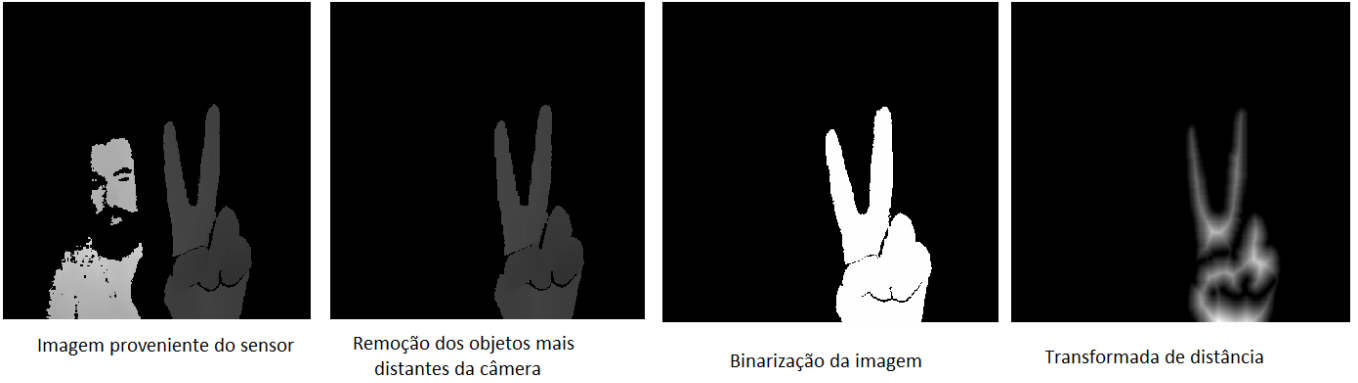
Fig. 1. Visão geral do método: geração da imagem usada como entrada para a rede neural convolucional.
