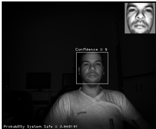
Figura 7. Execução do sistema. No topo é exibida a face normalizada e no canto inferior esquerdo a probabilidade do sistema estar seguro. Em cima da face é exibida sua similaridade.
