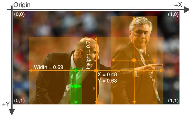
Figure 1. Exemplo de uma anotação YOLOv5 [6]
