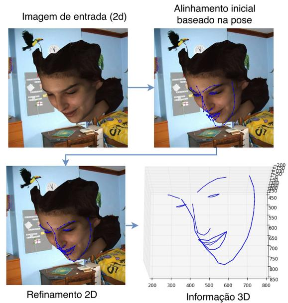
Fig. 5. Etapas do alinhamento desenvolvido: refinamento 2D dos pontos fiduciais previamente estimados pela pose e obtenção da informação 3D com base no 2D detectado.
