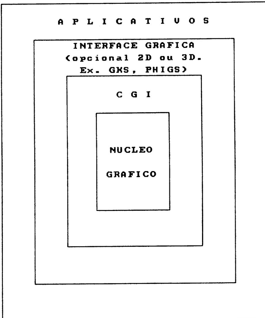
FIGURA 2: DIAGRAMA ESTRUTURAL DO SISTEMA SOFTWARE
