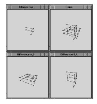
Figura 9: Combinações booleanas fechadas entre quatro faces.
