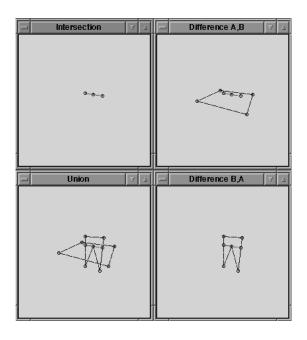
Figura 8: Combinações booleanas fechadas entre duas faces planares.
