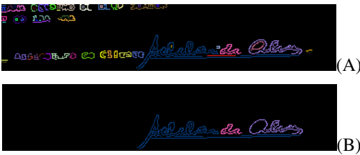
Figura 6. A imagem (A) mostra todos os elementos conectados encontrados na imagem de contornos. Já a imagem (B) mostra somente os três grupos que contém a maior quantidade de pixels.
