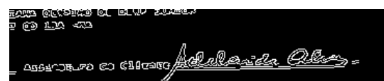
Figura 5. Simplificação da informação na imagem utilizando o detector de bordas de Canny.
