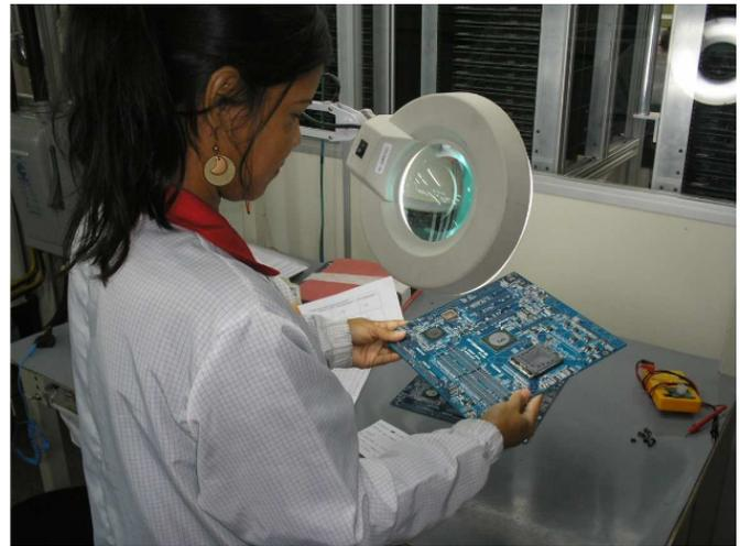
Figura 1. Inspeção visual convencional de placas mãe de computadores.
